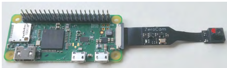
Abb. 6: Die Raspberry Pi Kamera am Raspberry Pi Zero
